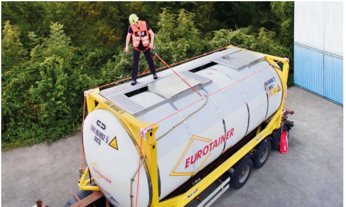
▲ Valstopsysteem op een dubbele demontabele lijn in gebruik bij het tanktransport
