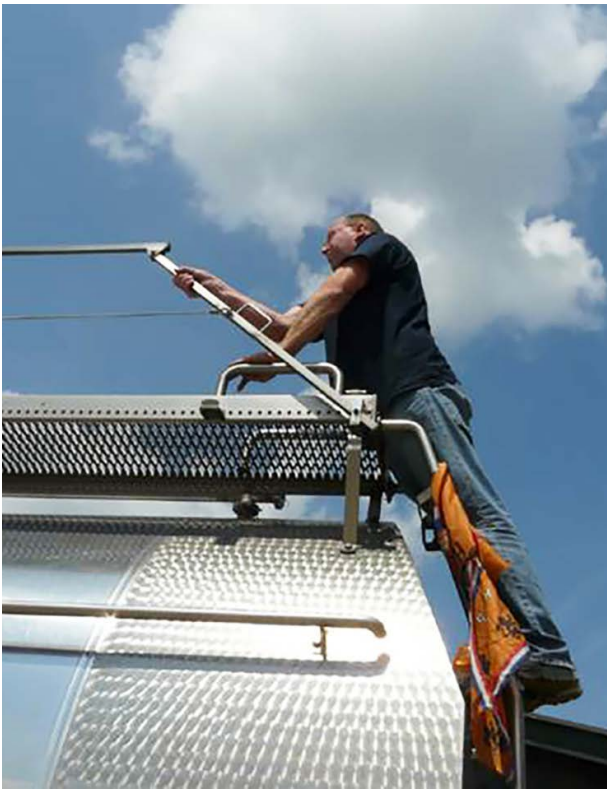
▲ Klaphekconstructie in het tanktransport
