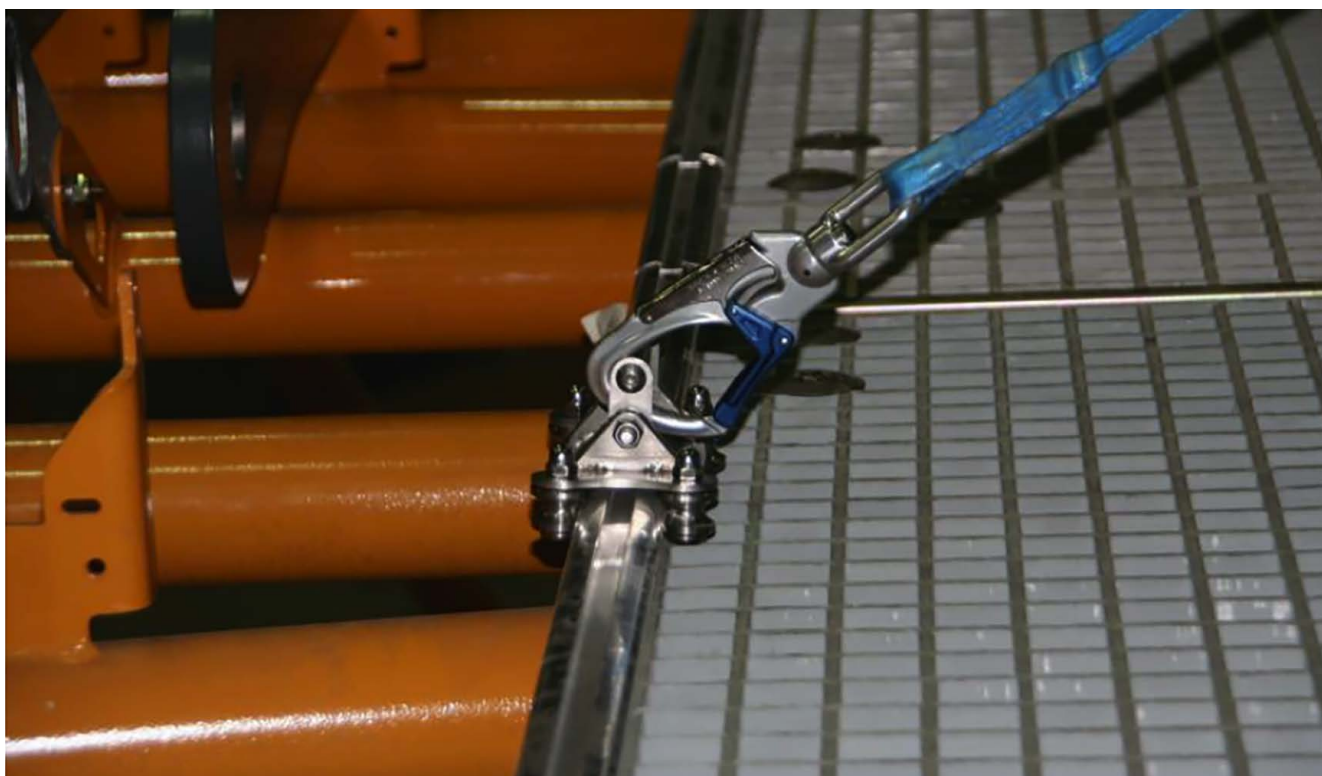
▲ Detail van het geleiderailsysteem
