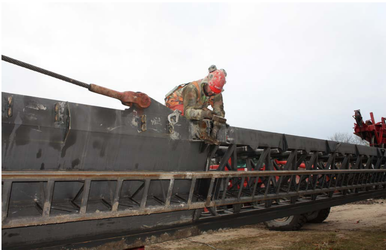
▲ Kort aangeliind (met vaste lijn) aan de makelaar zelf tijdens onderhoudswerkzaamheden op de makelaar
