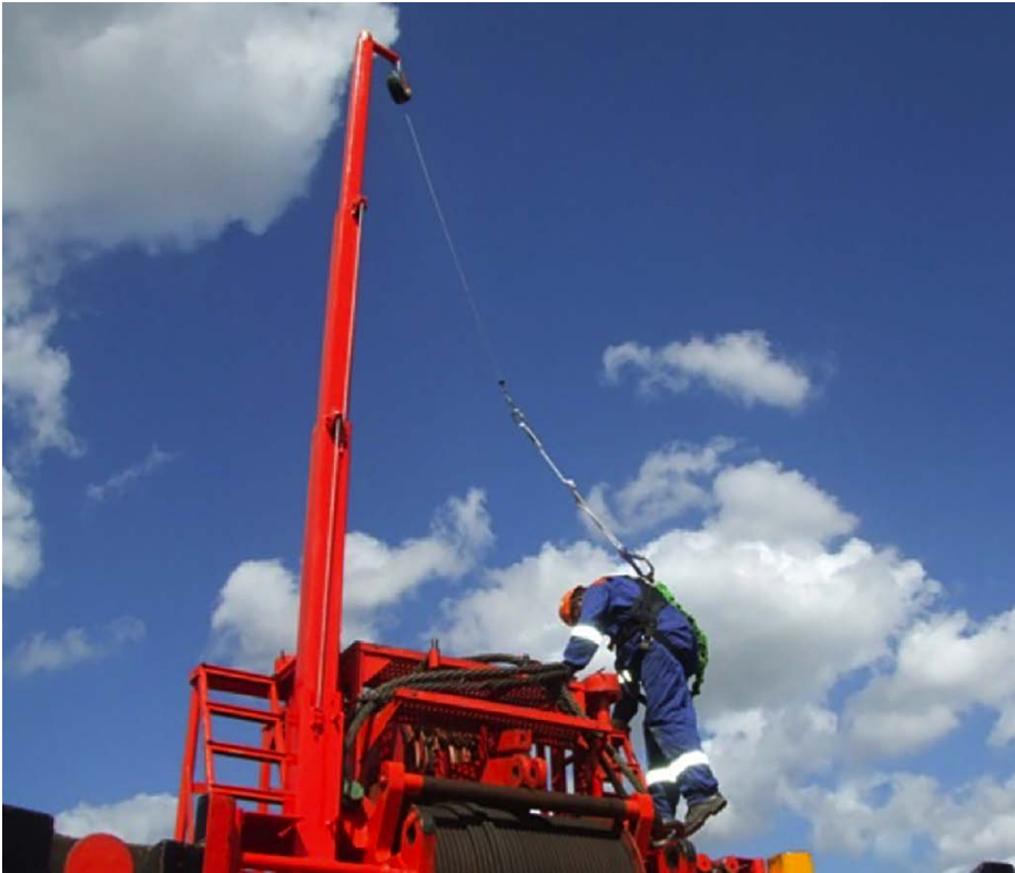
▴ Verankerde (draaibare) giek, die aanhaakmogelijkheid biedt boven schouderniveau
