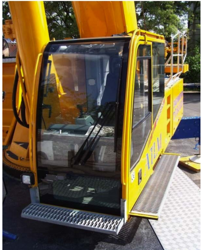
▴ Cabine met platform en rails voor driepuntsondersteuning
