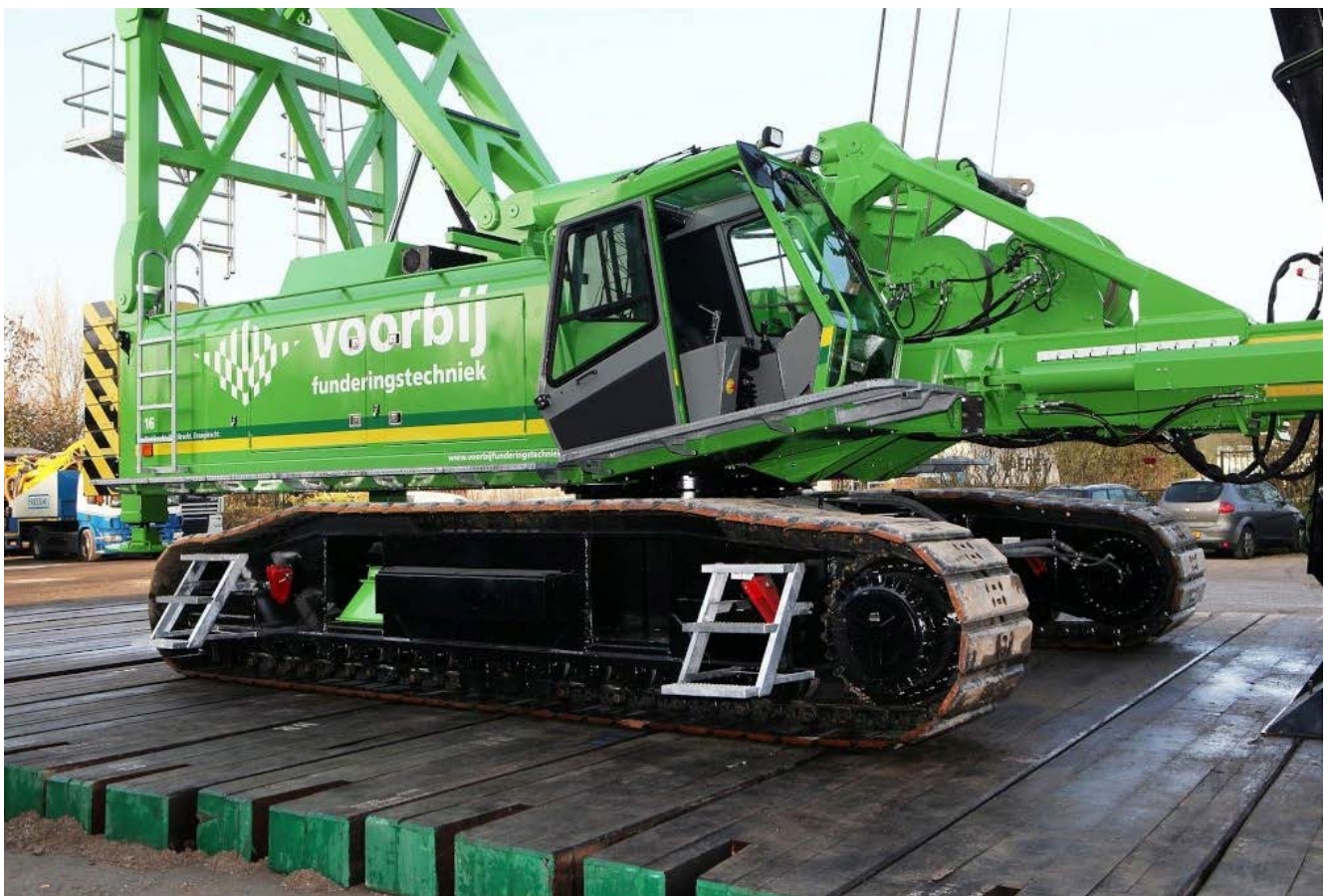
Machine voorzien van goed bereikbare trapjes, ladders en bordessen, ook bij het A-frame
