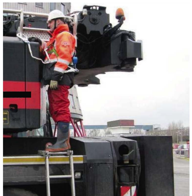
▴ Toepassen van harnassen met een vaste lijn t.b.v. onderhouds-, reparatie- en aftankwerkzaamheden
