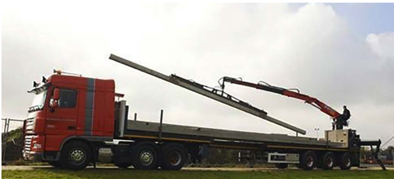
▲ Toepassing van zelfflossers
