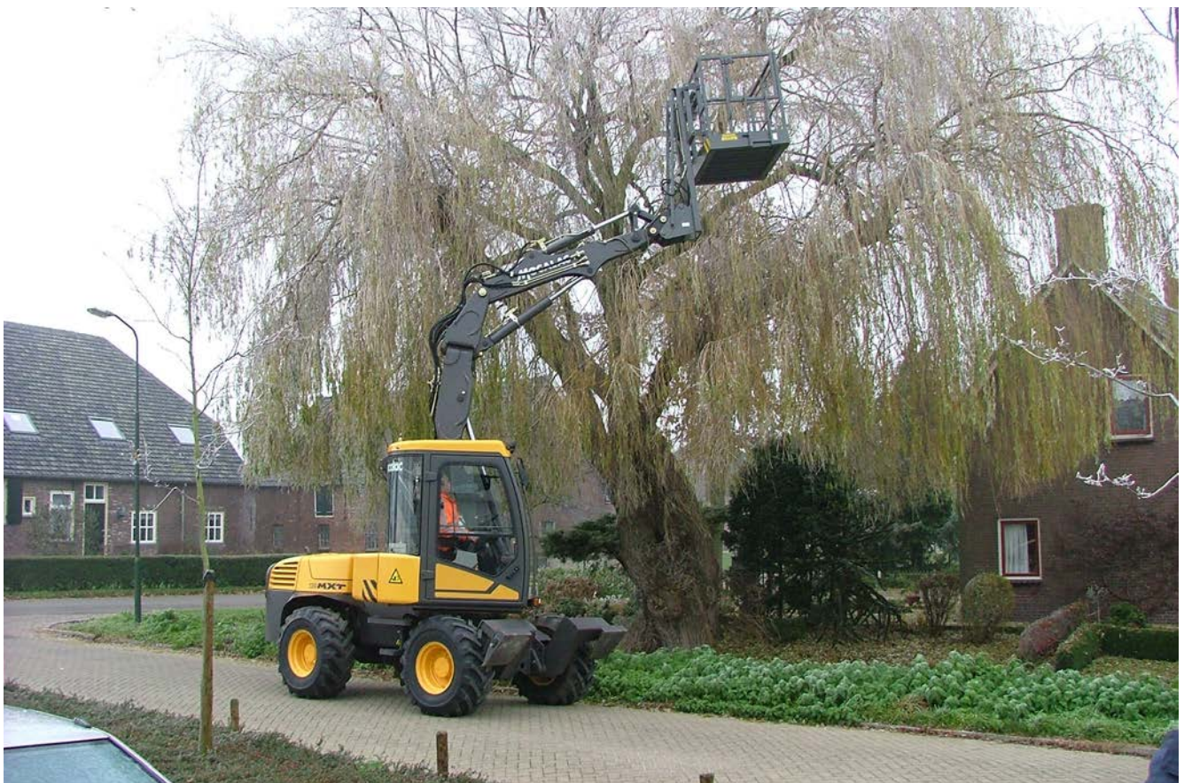
▲ Multifunctionele mobiele kraan voorzien van werkbak
