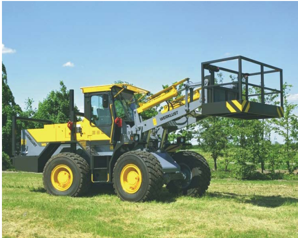
▲ Shovel voorzien van werkbak voor veilig werken op hoogte
