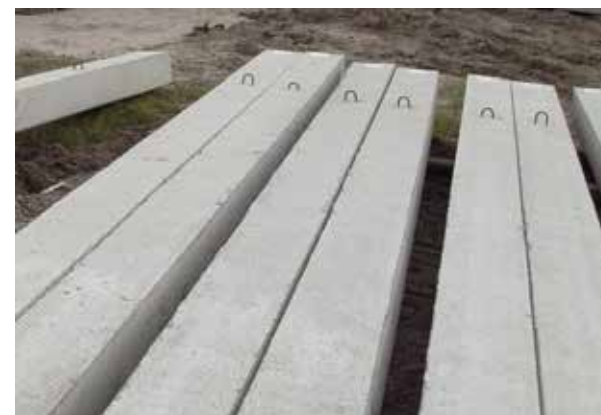
Betonpaal met ingestorte oog
