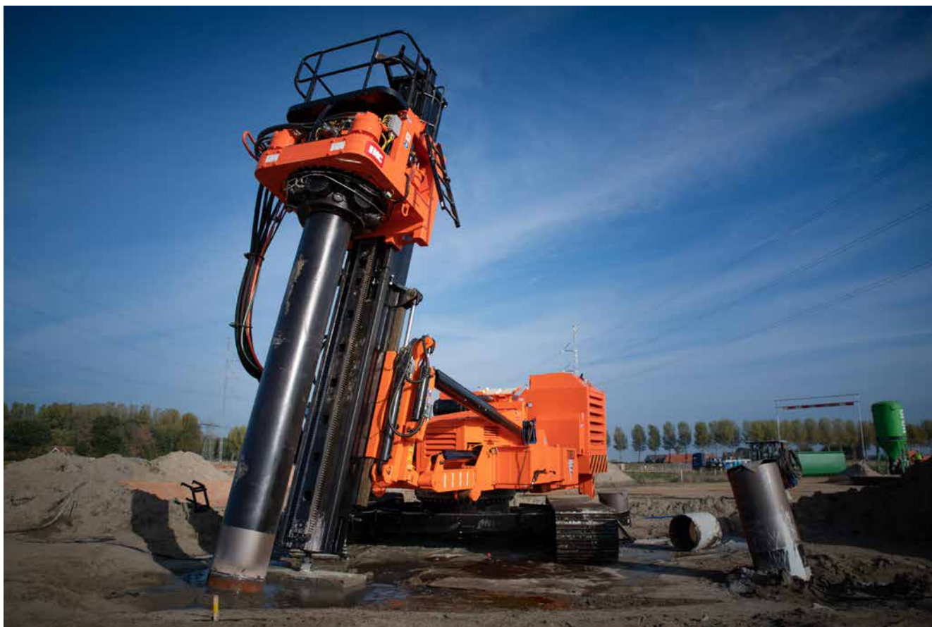
▼ Voorbeeld van een boormachine met doorvoermotor i.c.m. korte makelaar (D)
